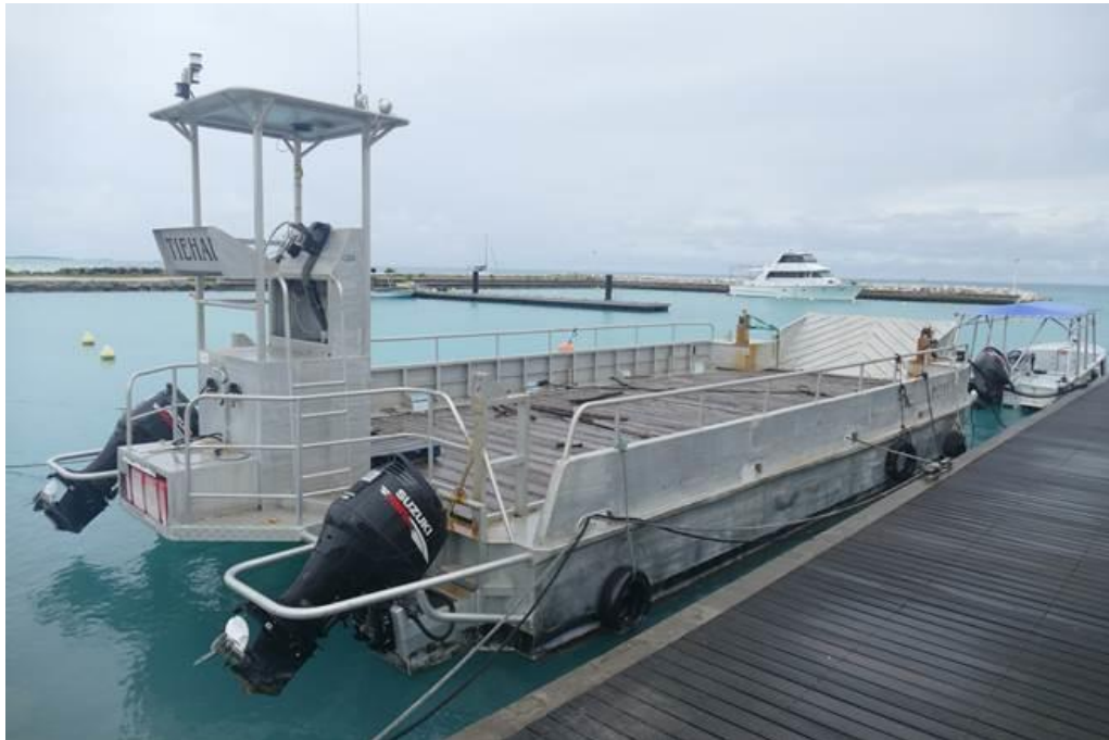
Barge de transbordement de l'atoll de Tikehau (Polynésie française), conçue pour transporter jusqu'à 23 tonnes
